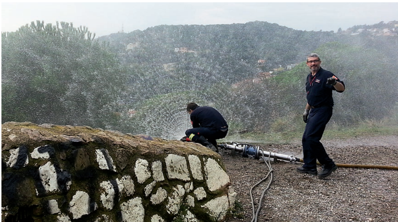
Proves de pressió fetes a la carretera de les Aigües per l'equip de bombers. Es pot observar l'acortinador d'aigua emprat connectat a l'hidrant.
